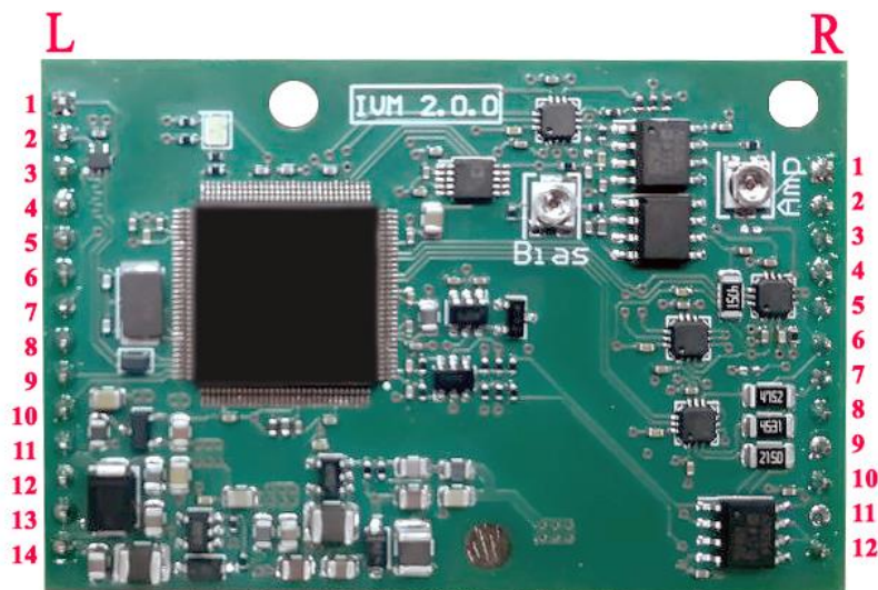
Рисунок 1. Внешний вид модуля EyePoint a2 и нумерация контактов разъемов L и R
