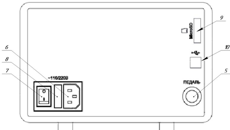
Рисунок 8. Вид устройства сзади
