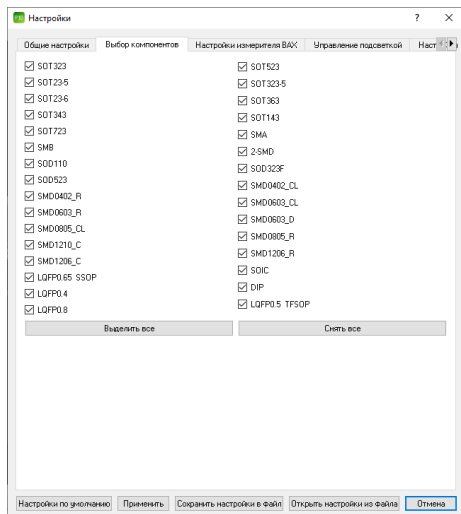
Рисунок 7. Вкладка «Выбор компонентов» окна настройки ПО EyePoint P10b.
