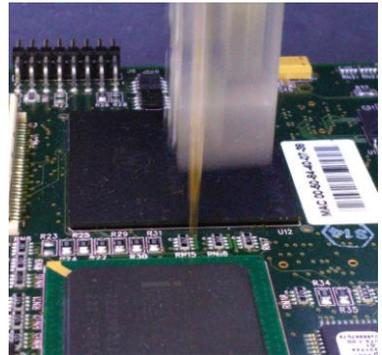
*Подвижный пробник типа "Летающий щуп" в действии, изображение тестирующей головки размыто из-за большой скорости движения щупа*
